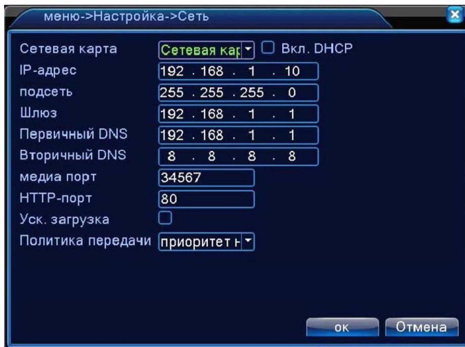
**СЕТЕВАЯ КАРТА:** Здесь вы можете выбрать сетевую карту. Функция ВКЛ. DHCP включает автоматическое получение IP-адреса (не рекомендуется).
